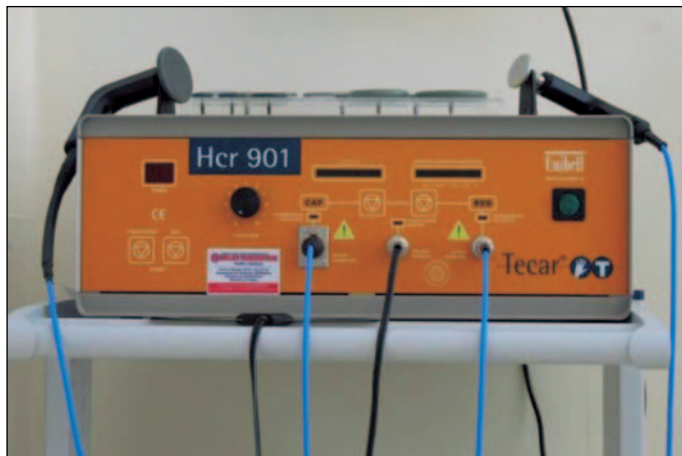
Figura 1. – Dispositivo di diatermia per il trasferimento energetico in modalità capacitiva e resistiva.
